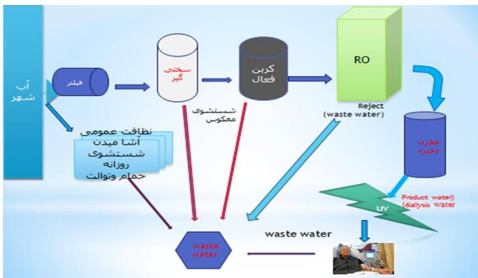
شکل ۱: نقاط نمونه برداری و پساب های تولیدی سیستم متعارف تصفیه آب بخش دیالیز (۸).
