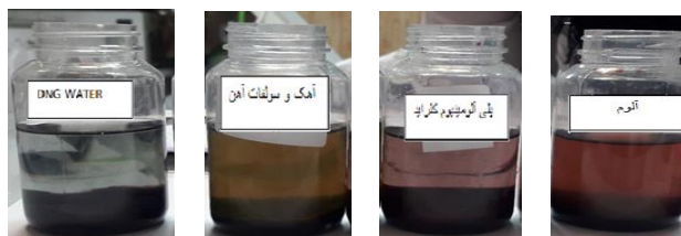
شکل شماره ۲. نتایج نهایی تصفیه پساب در مقیاس آزمایشگاهی
