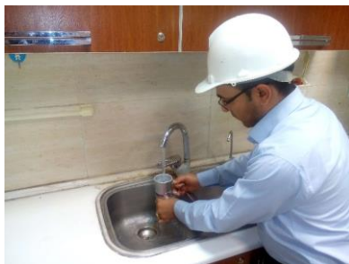
شکل شماره ۲- اندازه گیری میزان جریان خروجی تجهیزات توسط مهندسين ناظر مکانیک
