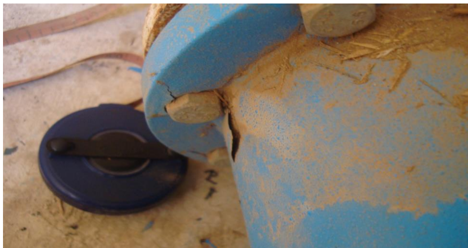
شکل ۳: کیفیت نامناسب سنسور و نحوه نامناسب نصب سنسور فلومتر الکترومغناطیسی
